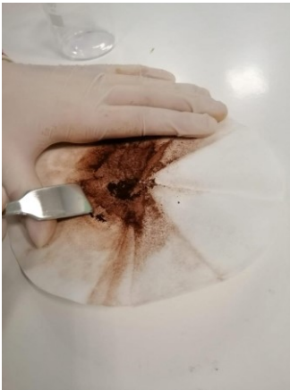
Deposito secco dello stagno essiccatosi nella filtrazione
